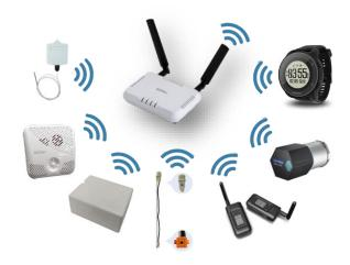
LoRaWAN®はスター型のネット ワークトポロジーで構成されます。 1つのゲートウェイに対して、多数 のセンサーデバイスが接続可能です。 センサー個別ではなく、ゲートウェ イが集約してインターネット接続を 行うことによって**通信費用のコスト** を削減します。 地域の課題解決に必要な機能をセレクトして整備。事後的な機能追加・拡張も、大規模な改修を行うことなく対応可能。
