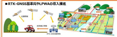
RTK-GNSS基準局の導入
