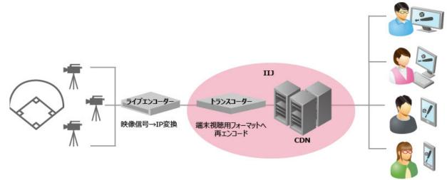
今回の中継には、インターネットのライブストリーミング配信に必要な機能をワンストップで提供するライブ中継ソリューションを使用しています。動画映像を配信したいお客様は、一つの映像ソースをインジェスト(映像信号をIP変換し、IIJのクラウドに送出)するだけで、TV、パソコン、スマートフォンなど各種視聴用端末に適した配信フォーマットに自動変換し、コンテンツをインターネット経由で視聴者に届けることができます。
