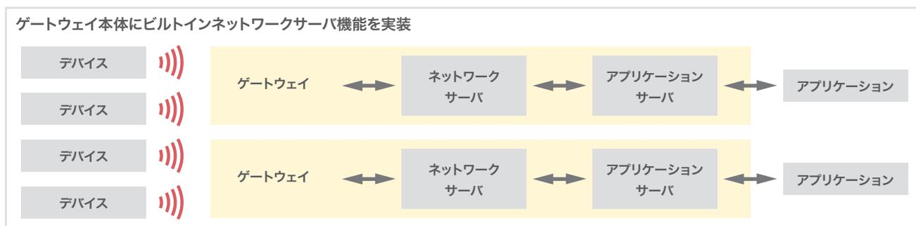
図-7 ビルトインネットワークサーバを活用したLoRaWAN<sup>®</sup>システム構成
